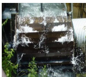
■ 「元気くん２号」 開放型下掛け水車 （流れ込み式）
