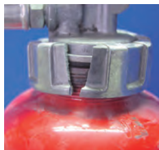
× キャップの破損
