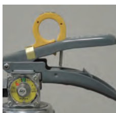
× レバー支えの脱落
