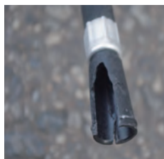
× ノズルの破損
