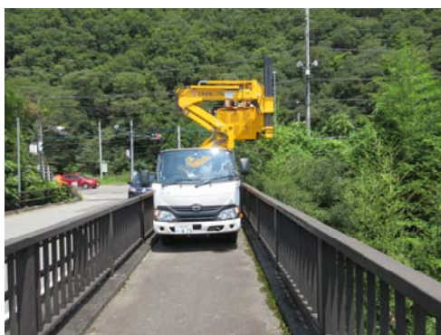
新技術活用事例（車両設置幅1.8mの道路施設点検車）
