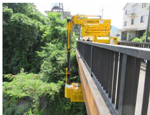
新技術活用事例（車両設置幅1.8mの道路施設点検車）
